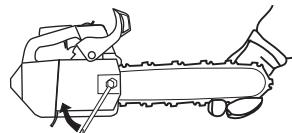
При установки новой цепи следует часто проверять ее натяжение , пока цепь не приработается. Регулярно проверяйте натяжение цепи. Регулярно проверяйте натяжение цепи. Правильно натянутая цепь обеспечивает высокое качество пилиния и дольше служит.
