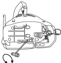
Когда топливо полностью израсходовано, масляный бак также обычно бывает почти пуст. Обязательно заполняйте масляный бак при каждой заправке пилы.
