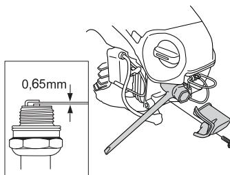
Обратите внимание! Всегда используйте только указанный тип свечи! Применение несоответствующей модели может привести к серьезным повреждениям поршня/цилиндра. Следите за тем, чтобы свеча была оснащена т.н. изоляцией радиопомех.
